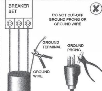
DO NOT CUT-OFF GROUND PRONG OR GROUND WIRE
